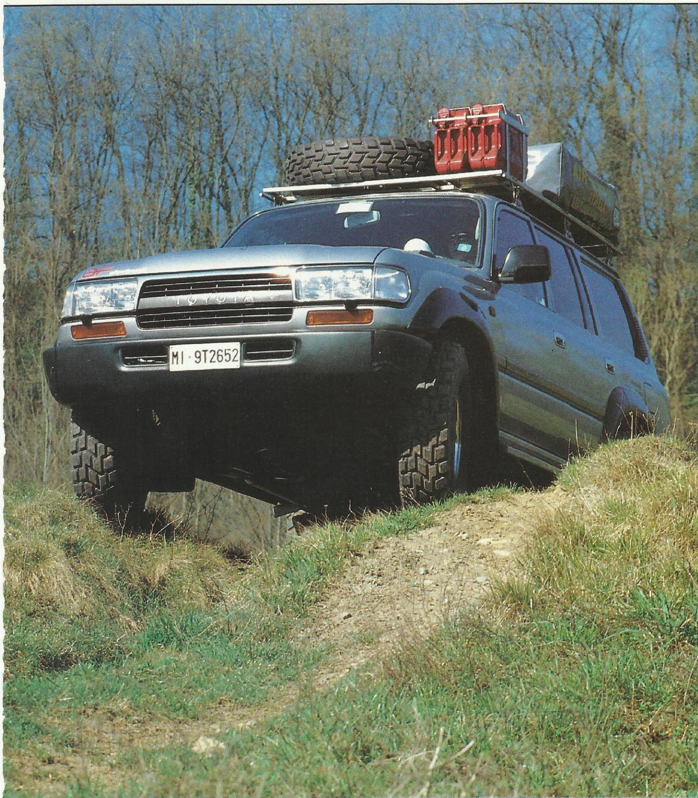
**L'imponente Toyota HDJ 80 con il sapiente allestimento per affrontare in sicurezza i viaggi più impegnativi. La grossa 4x4 giapponese con motore 6 cilindri turbodiesel di 4164 centimetri cubi sviluppa 167 cavalli a 3600 giri al minuto, con una velocità massima di 170 chilometri all'ora. Dispone di trazione integrale permanente.**
