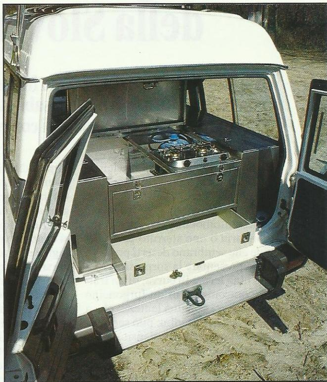
pletato da una bagagliaia in acciaio inox studiata per impieghi pesanti e caratterizzata da piedini con una superficie d'appoggio sul gocciolatoio da 2 a 5 volte superiore a quella offerta dai piedini di disegno convenzionale. La bagagliaia è inoltre dotata di bulloneria autobloccante in acciaio inossidabile.
