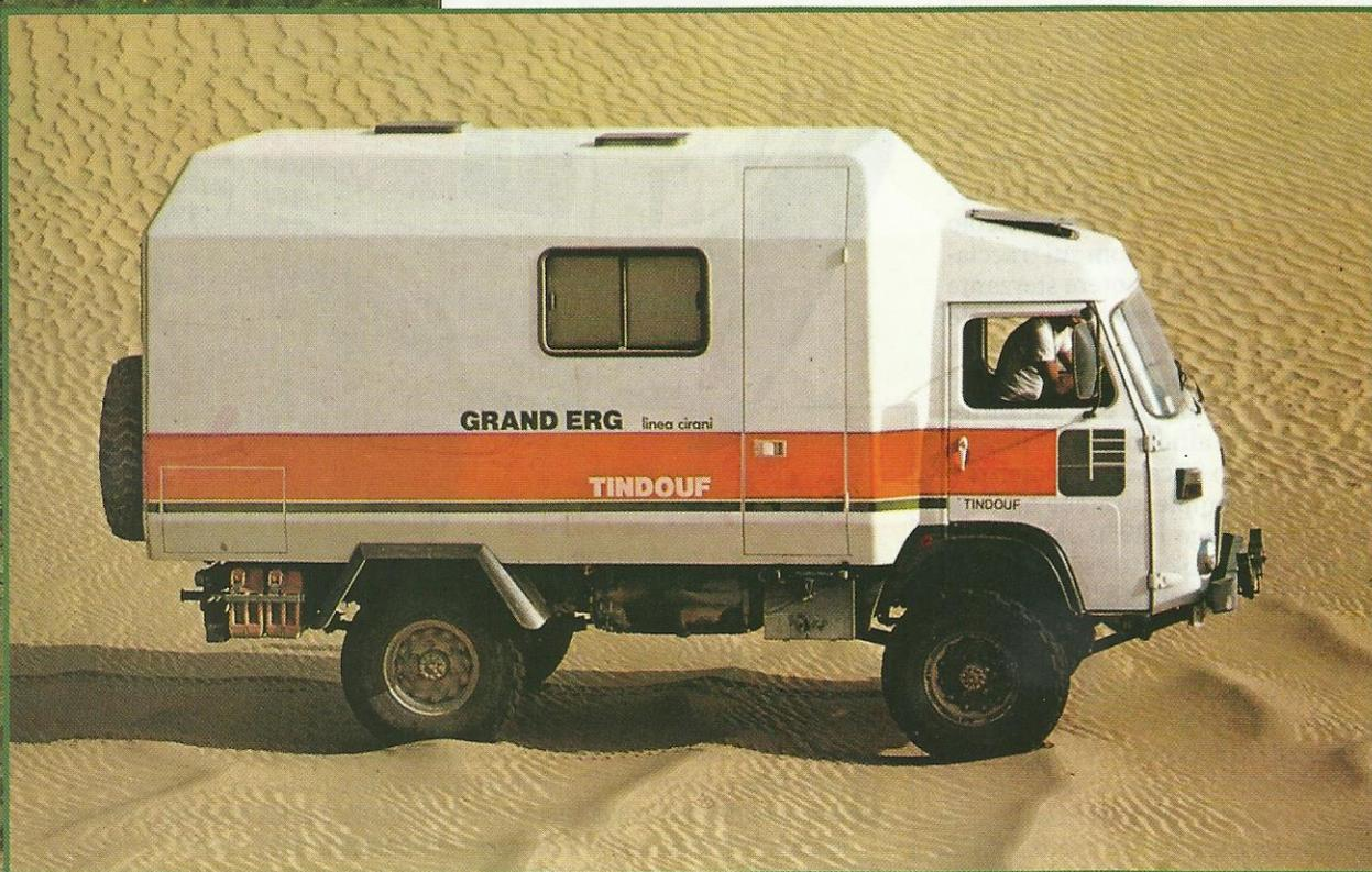
Nonostante l'anzianità della meccanica, il camper realizzato dalla Grand Erg sul telaio Renault TP3 è ancora oggi valido per scoprire senza fretta gli angoli più belli e isolati del nostro pianeta. Sullo sterrato mantiene medie discrete, e le sospensioni a balestra entrano in crisi solo in presenza di buche e di terreno particolarmente duro.
