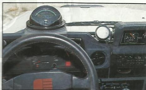
**MONITOR** Il piccolo schermo con le funzioni di comando del satellitare GPS è fissato internamente sopra il parabrezza. Con il satellitare la "navigazione" è più sicura.
